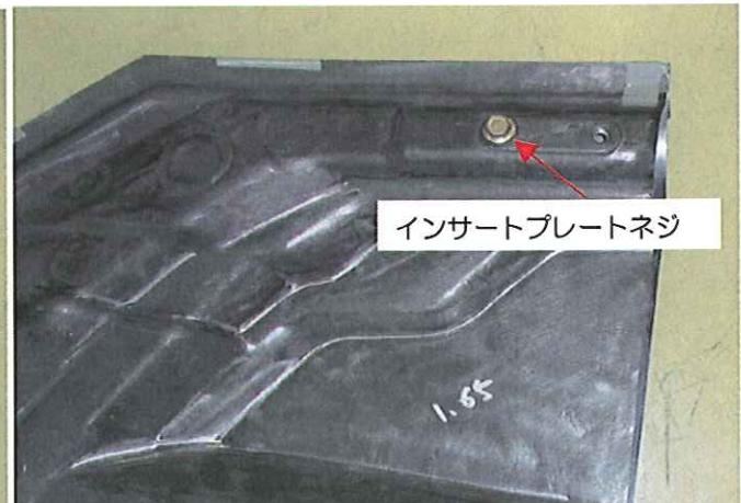
図-18 CF-SMC インサート成形加工
