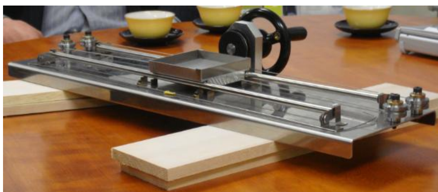
図 2-3 移動部の試作機（台車およびレール）
