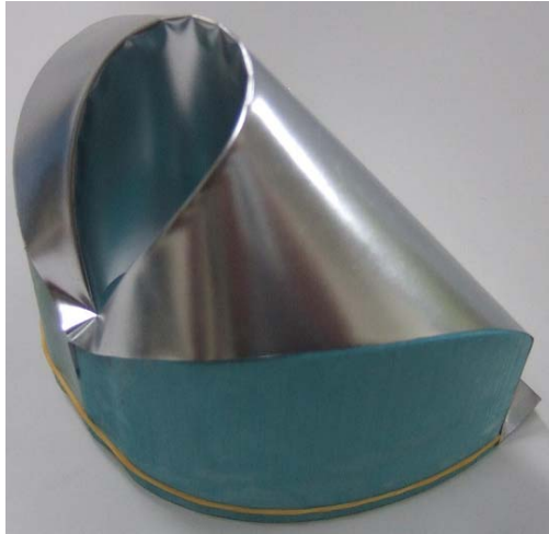
図 3-3-1 シール部分の型を追加した試作品
