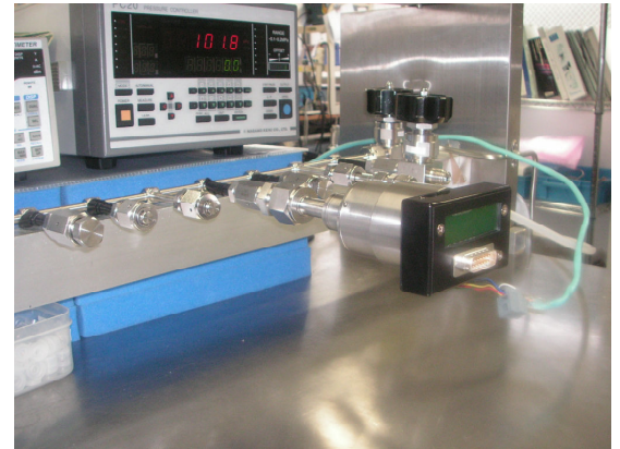
圧力発生器及び真空ポンプを使用した測定風景
