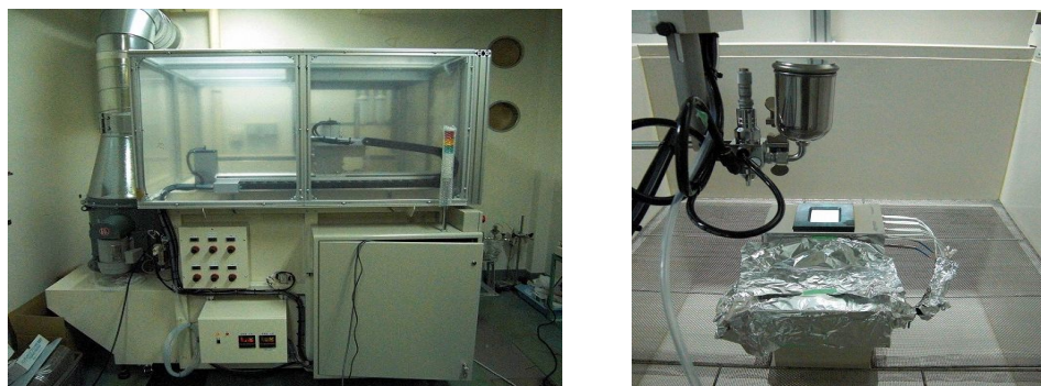
図6 スプレー装置外観およびスプレー部分写真
