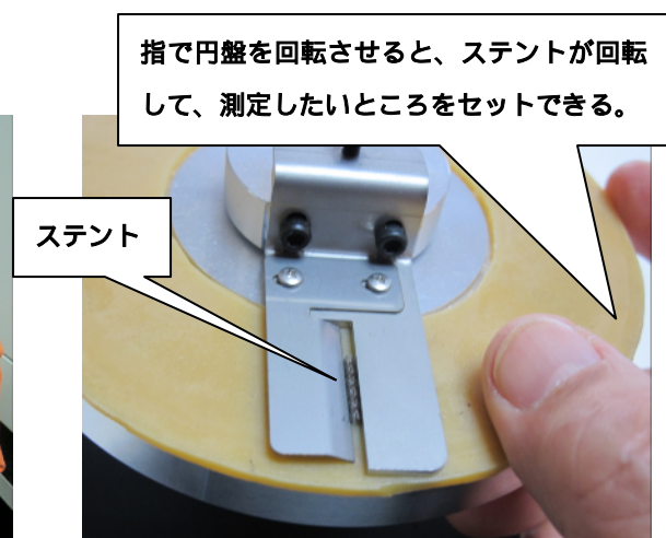
図 1-4 補助治具の測定部拡大
