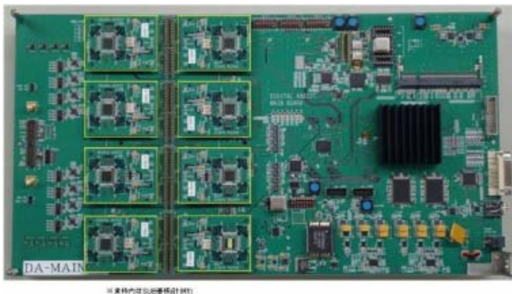
図 4 - 1 . 1 AD コンバータ仮実装評価用基板 (MAIN 基板 + SUB 基板勘合状態)
