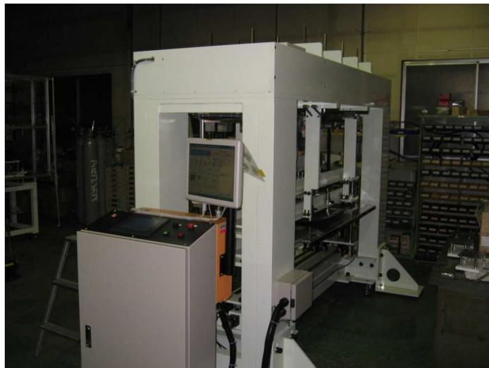
図 2-4-2 次世代ニードルパンチ加工装置の全体写真
