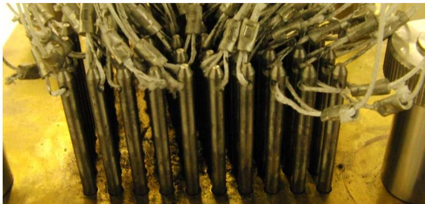
図 2-1-1 上下動作による通糸の摩耗状況
