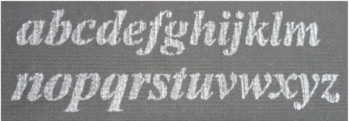
図 2-5-6 上下動作速度 60rpm : 定速運転の加工結果
