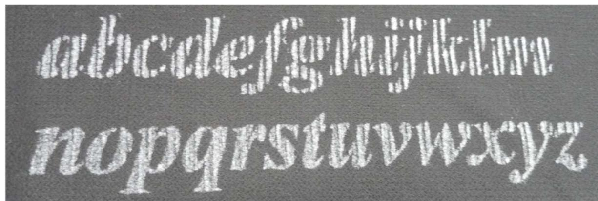
図 2-5-9 上下動作速度 80rpm : 同期運転の加工結果
