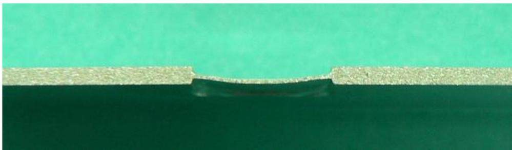
図 2.6.1.32 コイニング製品断面
