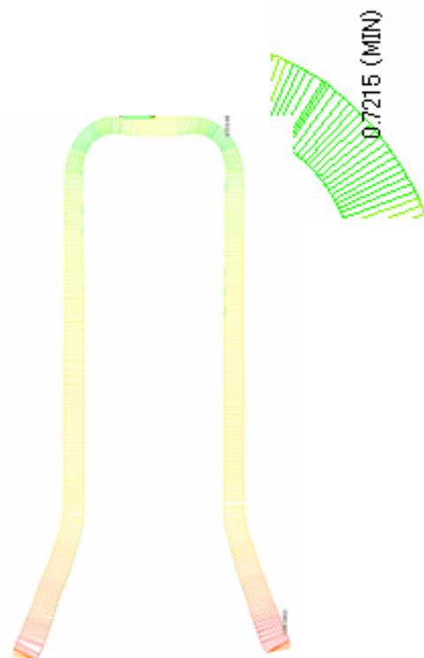
データは、3次元測定機に専用測定治具を使用、 $\phi 2$ プローブでの接触測定による
