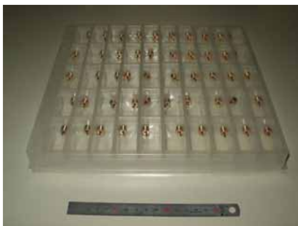
図 2.4-1 試供ボールジョイント外観
