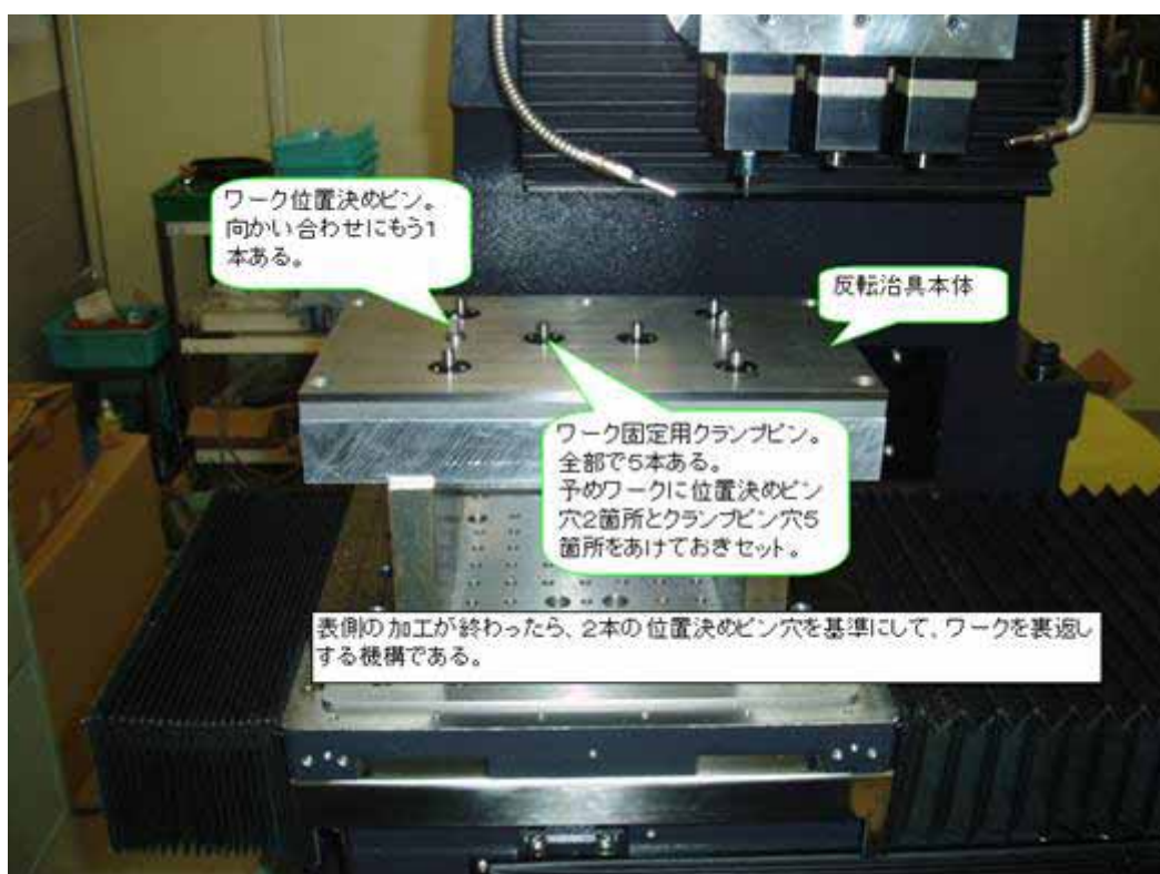
写真 2-7 反転機構を持った精密加工治具
