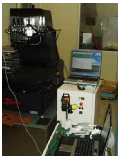
写真 2-8 切削動力計の取り付け
