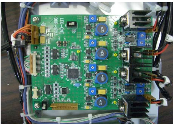
図 9 照明制御基板
