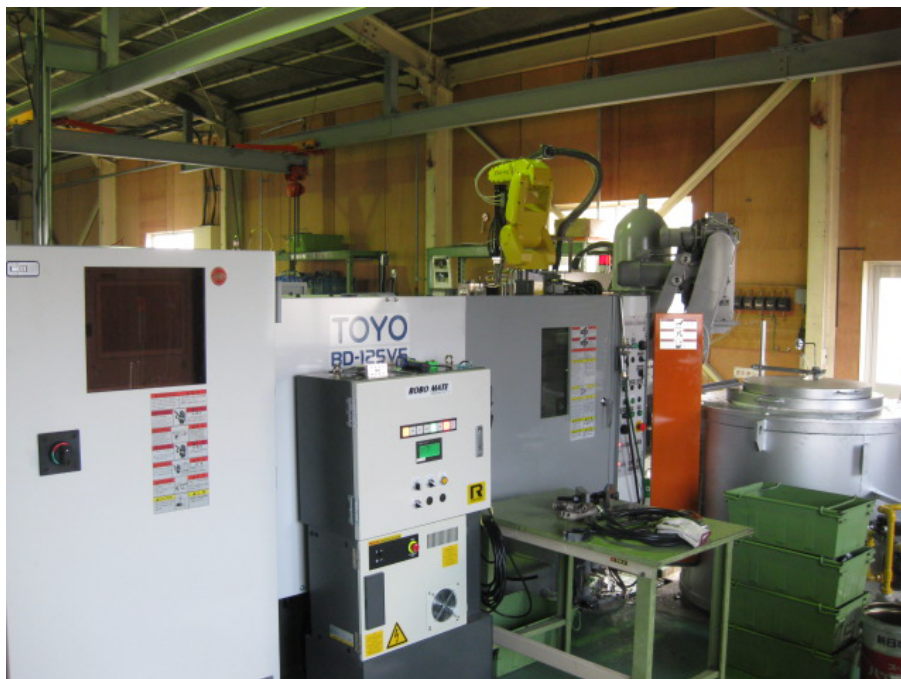
図 2-3-6 ダイカストマシンの外観 (東洋機械金属(株)製 BD-125V5)
