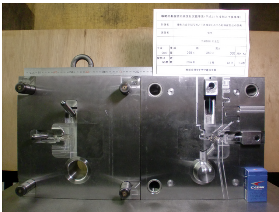
図 2-3-5 光ピックアップのダイカスト用金型
