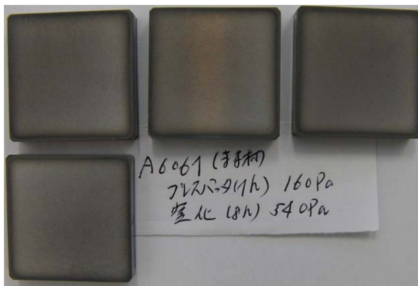
図2-1-6 A6061の未研削材のプラズマ窒化8時間後の表面状態
