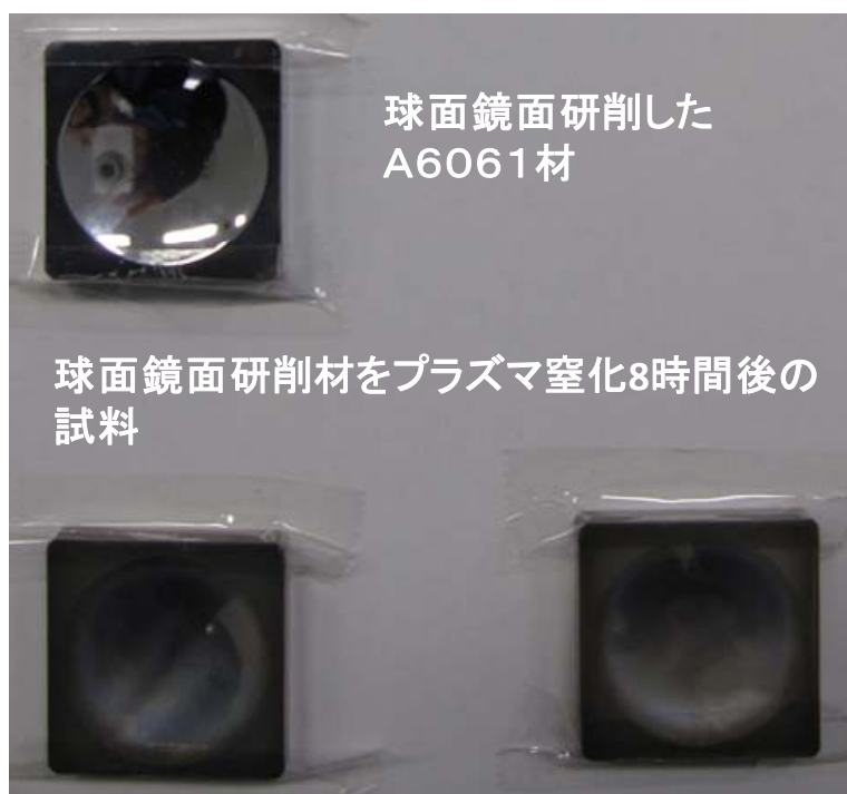
図 2-1-8 球面鏡面加工した A 6 0 6 1 材のプラズマ窒化による変化
