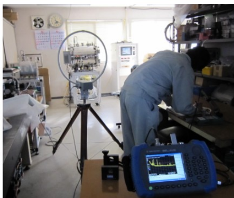
写真1-1-5 ノイズ測定の様子
