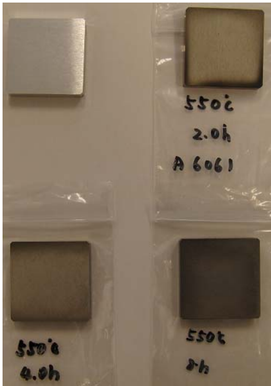
図 1-3-1 550℃プラズマ窒化したA6061 試料
