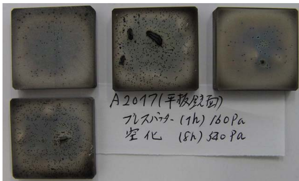
図2-1-4 表面鏡面研削したA2017材のプラズマ窒化8時間後の表面
