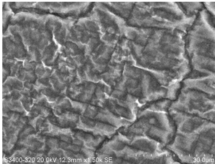
図2-1-9 b) 高倍率でのSEM像（平面研削したA6061 材のプラズマ窒化8時間後）
