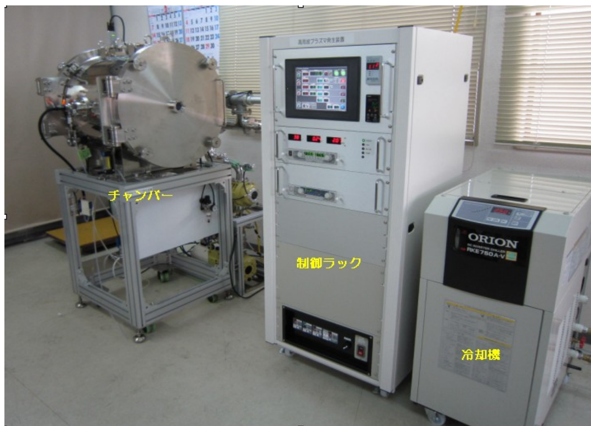
写真1-1-1 開発したプラズマ装置
