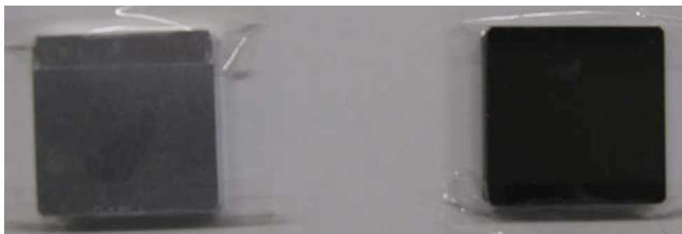
図1-3-8 A2017材のプラズマ窒化：左が窒化前、右が窒化後。
