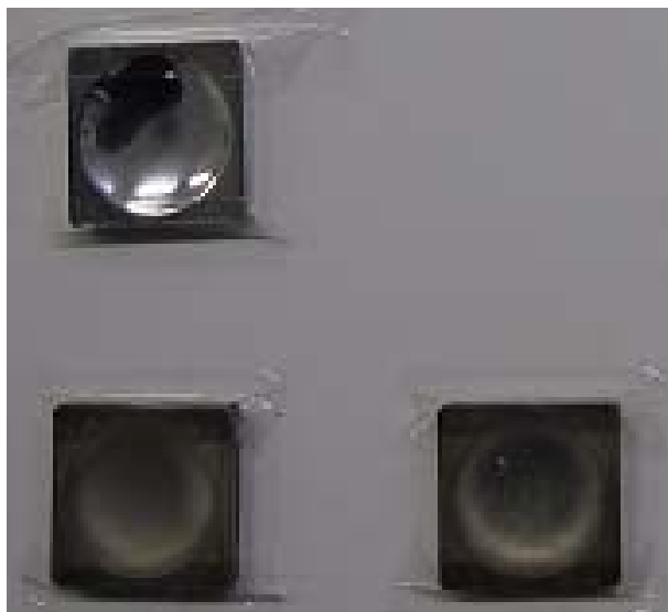
図2-1-5 球面鏡面加工したA2017材と8時間プラズマ窒化の表面比較
