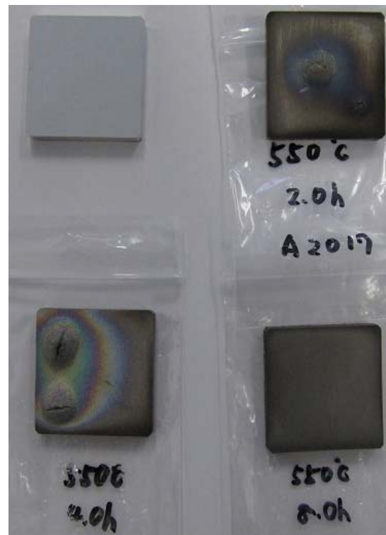
図 1-3-2 550℃プラズマ窒化したA2017 試料
