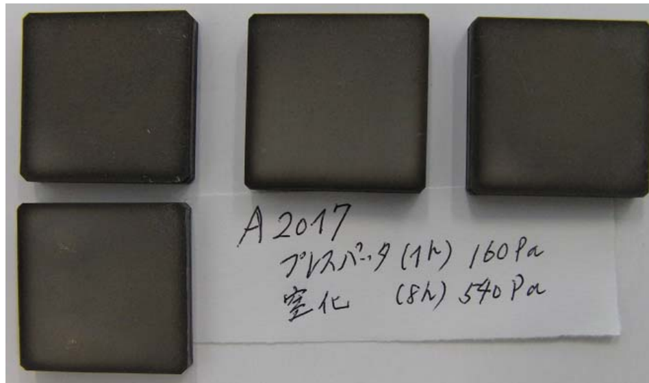
図2-1-3 標準表面粗さをもつA2017材の8時間プラズマ窒化後の表面状態
