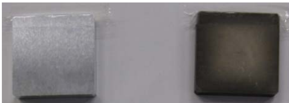
図 1-3-7 A6061 材のプラズマ窒化：左が窒化前、右が窒化後
