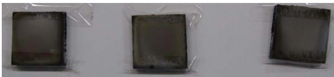
図2-1-2 A2024材のプラズマ窒化結果。
