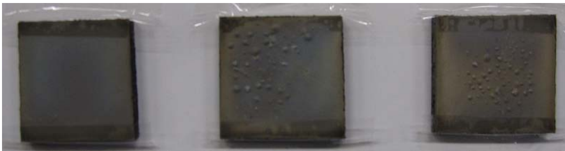
図2-1-1 A2021材のプラズマ窒化結果。場所による差異はないが、過剰な表面反応による突起が観察される。
