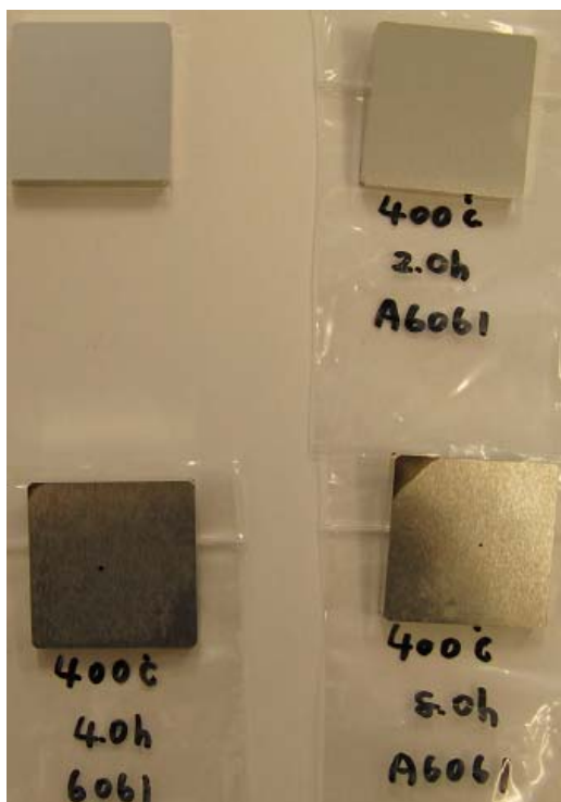
図1-3-4 400°Cプラズマ窒化したA6061 試料。
