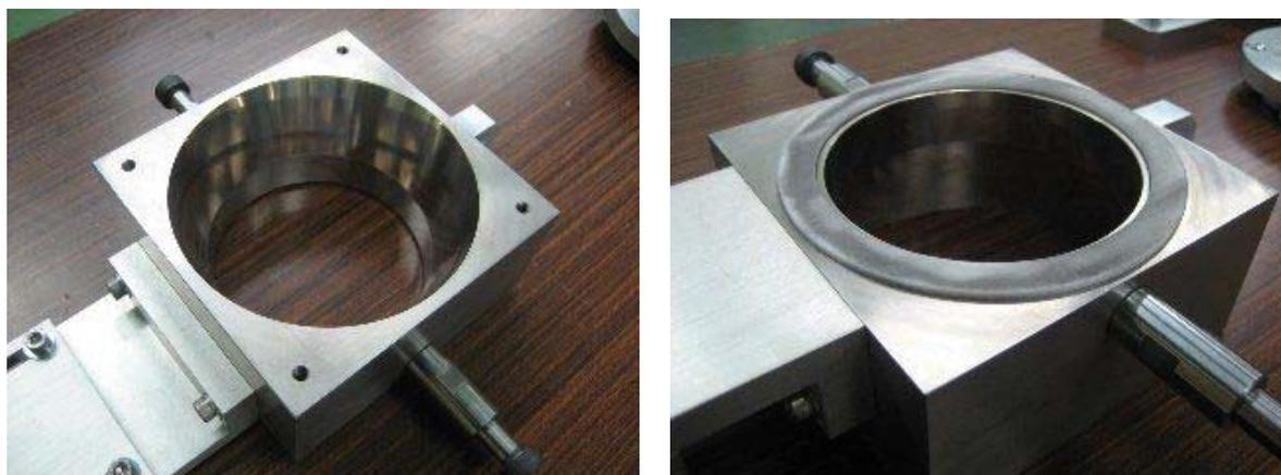
図 1 2 フィーダーボックス形状、摺動面
