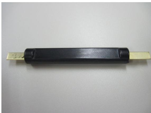
図 2.4.1-3 接着強度試験およびガスリーク試験片の概観
