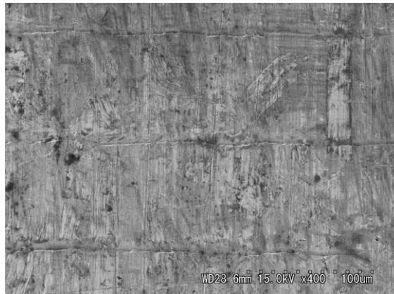
図 2.1.2-12 軽加工条件における精密微細加工面/パンチ加工面
