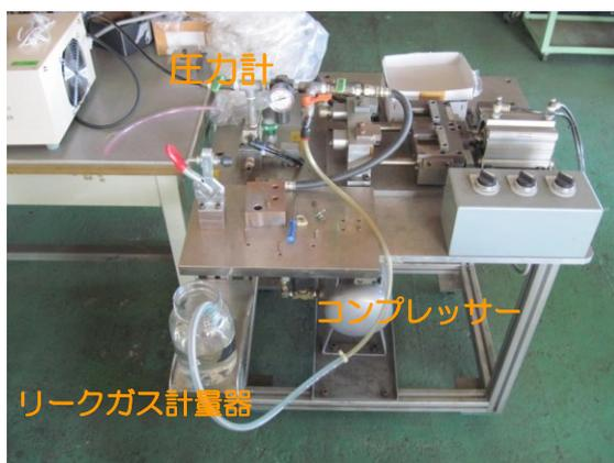
図 2.4.1-7 ガスリーク試験装置
