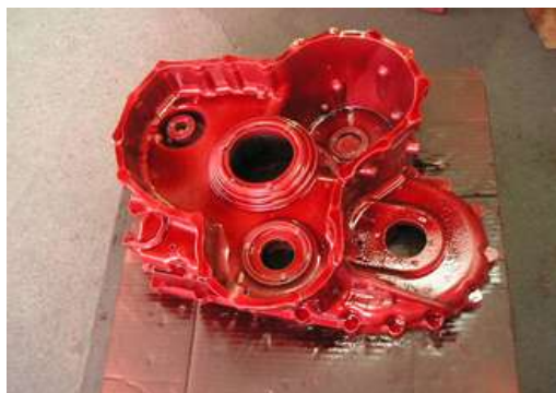
＜試験鑄造品への浸透探傷液塗布＞
