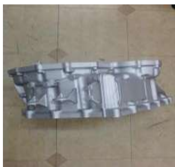
図 2-12 第3段階試験鑄造品（完成品）
