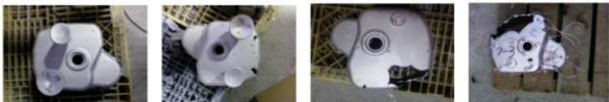
図2-11 第1段階試験鋳造品事例
