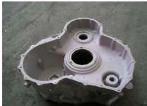
＜浸透探傷液洗浄乾燥後の現像液塗布状態＞
