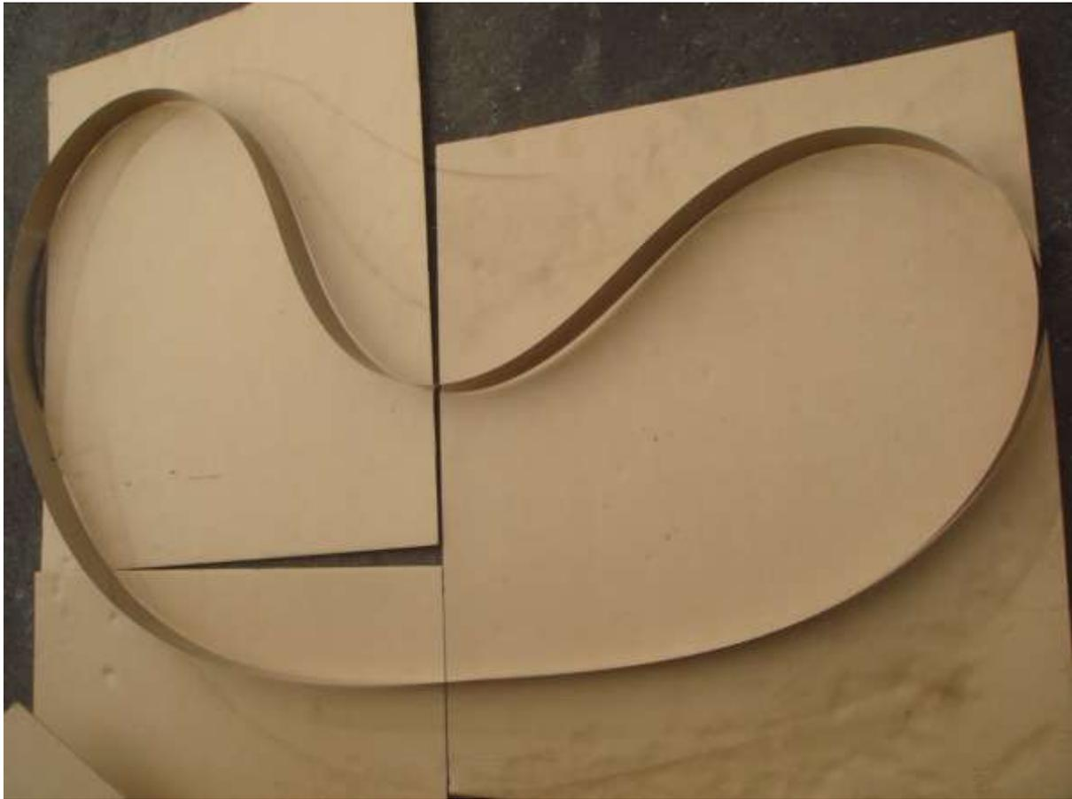
写真9 完成した刃厚1.5mmバンドソー全体
