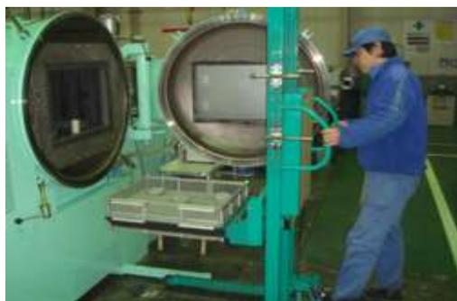
写真3 真空炉への投入
