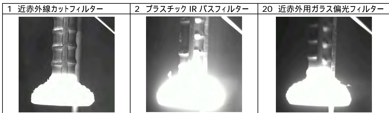
図4 フィルター選定撮影実験の撮影画像
