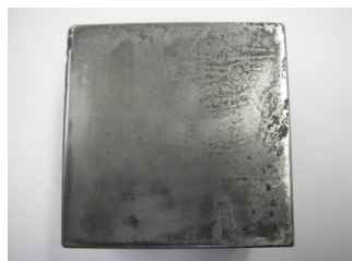
Ni(ニッケル)系化合物の成長 アルミニウム合金溶湯内 4 h
