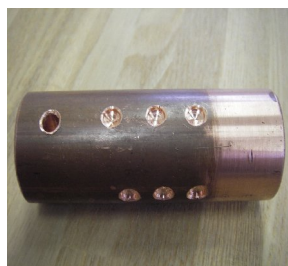
Cu(銅)合金の溶損 アルミニウム合金溶湯内 2 h
