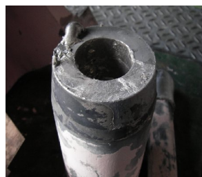
ファインセラミックの破損 アルミニウム合金溶湯内使用 0 h
