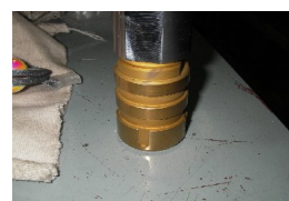
オリジナル合金射出機構部品 3層CVD プランジャー寸法：B Type
