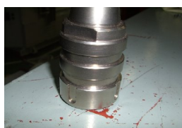
オリジナル合金射出機構部品 高温塩浴拡散皮膜 Type B プランジャー寸法：B Type
