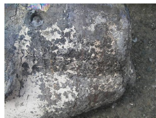
Fe(鉄)系化合物の成長 アルミニウム合金溶湯内 8 h
