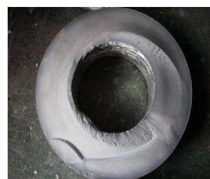
ファインセラミックの破損 アルミニウム合金溶湯内使用 0 h
