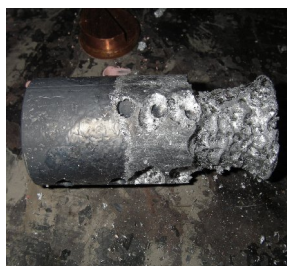
Cu(銅)合金の溶損 アルミニウム合金溶湯内 2 h
