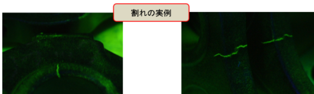
図 6-6 磁粉探傷による割れ検出例
