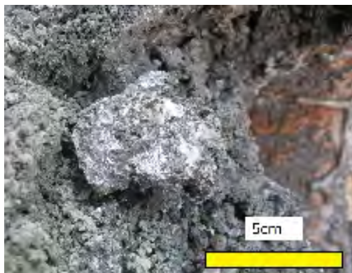
写真 5. 粒状珪藻土から生成した金属シリコン
