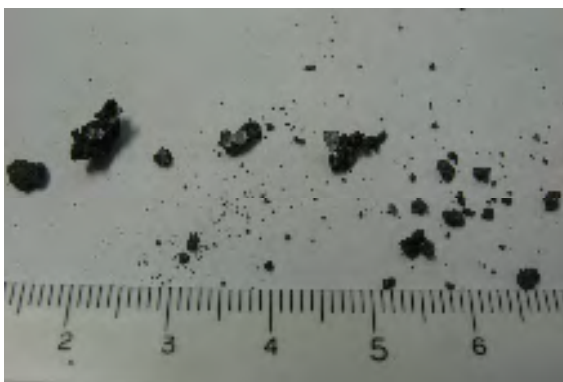
写真 6. (株)サーモニックの Ar 雰囲気中でできた金属シリコン
