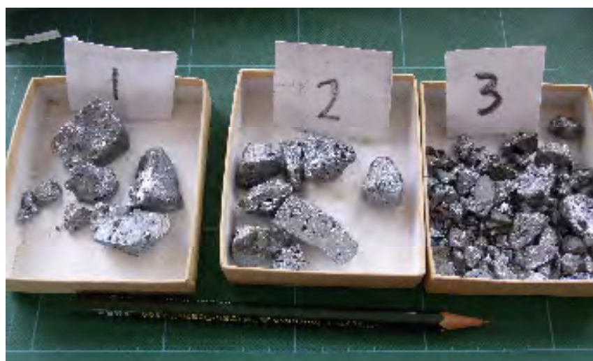
写真 22. 第 1 回の徐冷実験用の試料（アンドー工業所で 7 月に作ったものを再度融解）
