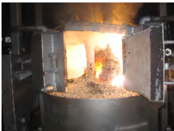
写真 2. 運転中のアーク炉。Si の蒸発によるシリカヒュームの白煙が発生し、電極にガラスや炭化珪素が付着している。
