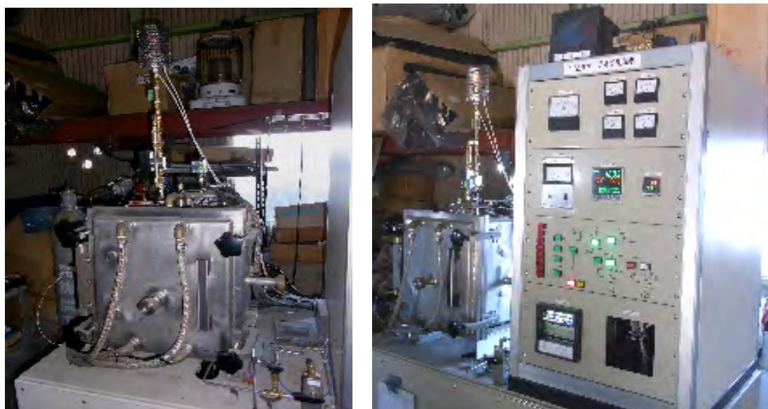
写真 21. 株式会社サーモニック四街道工場の実験装置（小形真空メタル炉） 左の正方形の炉体に試料を入れる。右は制御盤。
