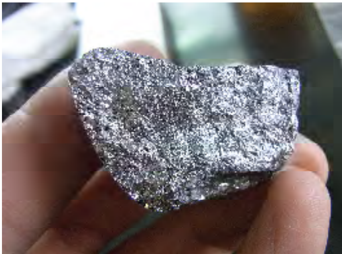
写真 23. 徐冷実験後の金属シリコンの破断面
