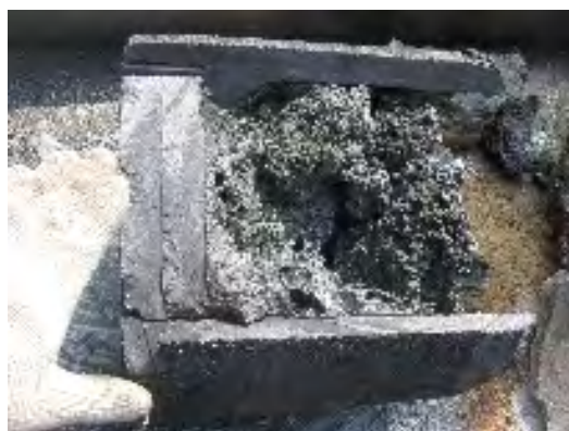
写真 4. 写真 3 の坩堝の切断状況（粒状珪藻土で実験）。炭化珪素やガラスに混ざり、粒状の金属シリコ
