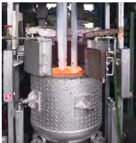
写真 1. (株)アンドー工業所の大気雰囲気アーク炉。坩堝（中央）に上から3本の電極を挿入
