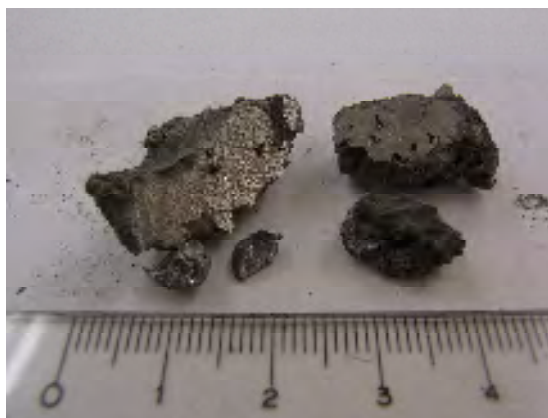
写真 9. 製作したアーク炉で得られた金属シリコン
