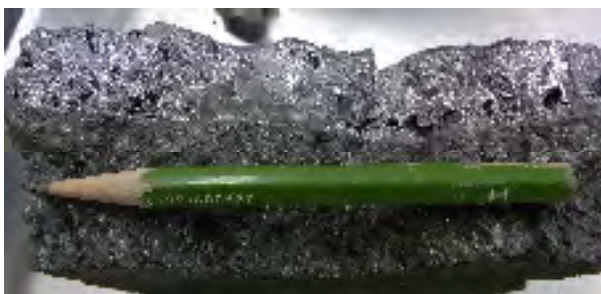
写真 15. 写真 14 の金属シリコン塊の拡大（ガラス部分は除去）
