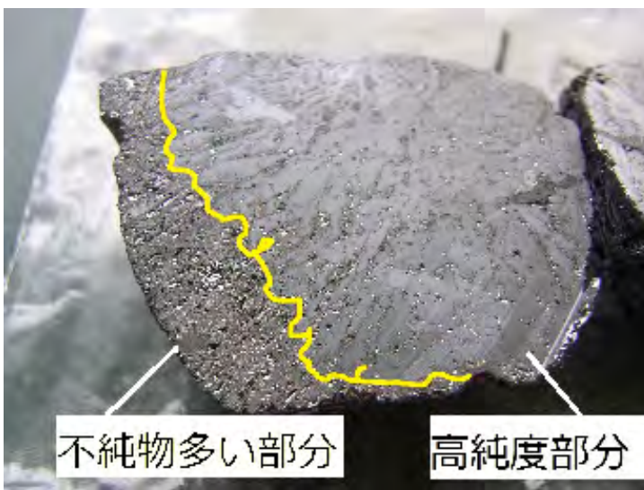
写真 24. 高純度化実験試料の切断面
