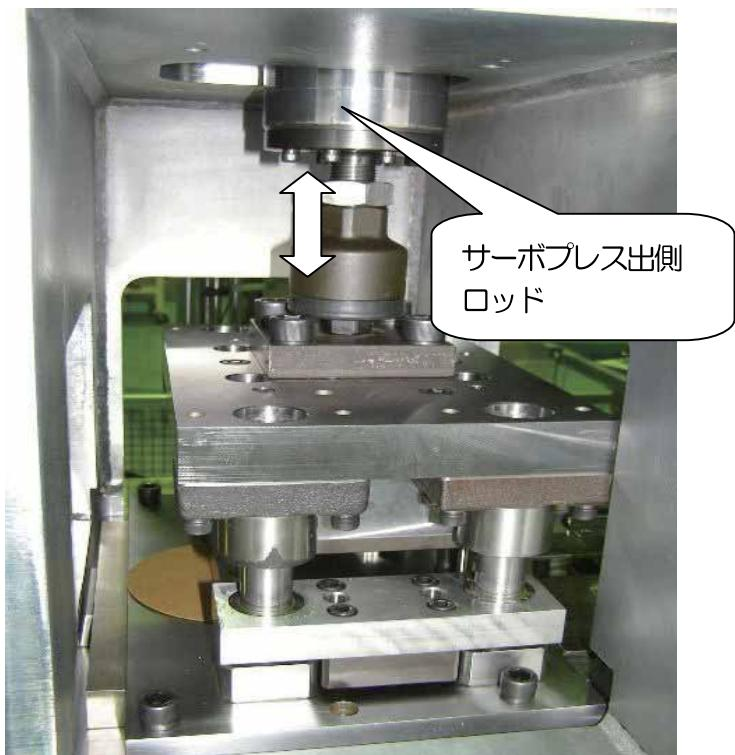
図7 サーボプレス出側ロッドと金型
