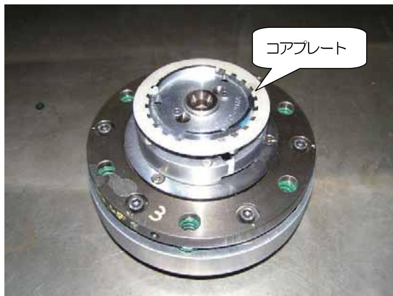
図11 ワーク投入後のワーク治具
