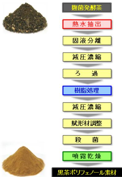
図2. 黒茶ポリフェノールの樹脂処理工程
