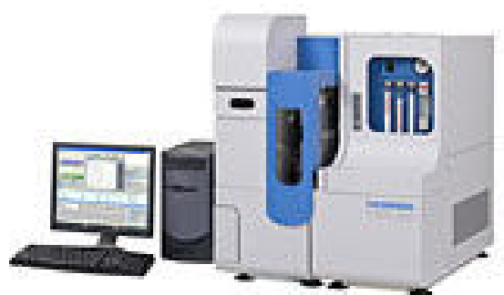
図16 導入した酸素・水素分析装置
