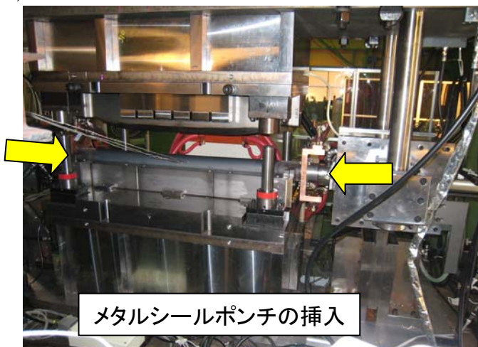
図3 メタルシールポンチの挿入
