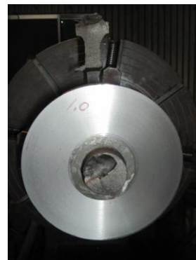
図 7-2 ドロス欠陥試験鑄物の概観
