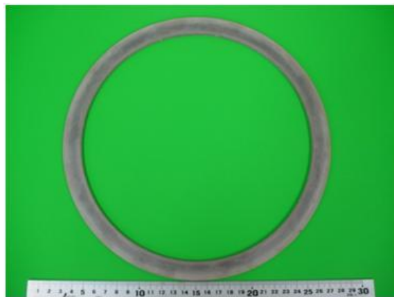
図 2-2-2 高密度アルミナ材料の試料外観
