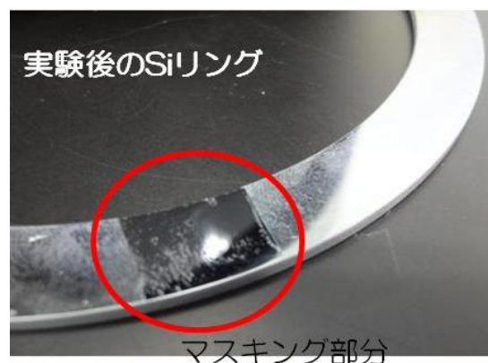
図 2-2-8 エッチング評価後の Si リング
