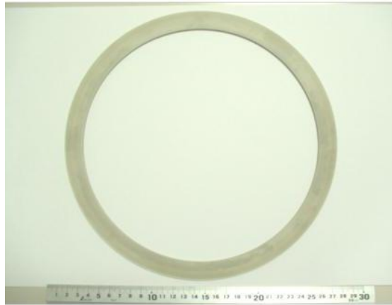
図 2-2-1 高密度イットリア材料の試料外観
