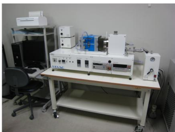
図 2-2-4 電気伝導特性評価装置
