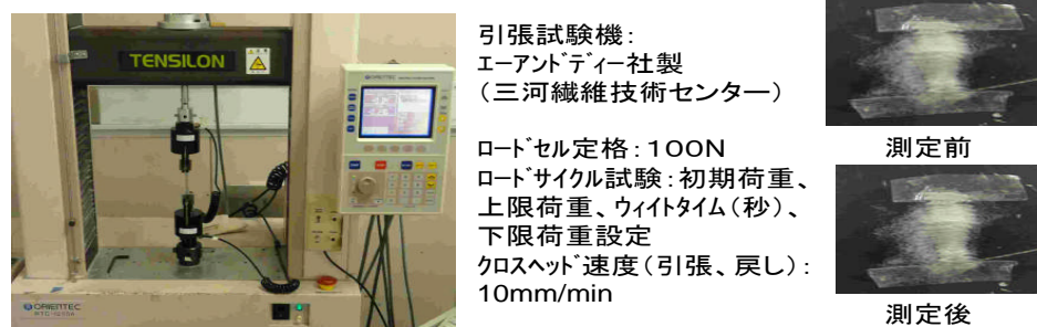
図2-5-2 引張試験機、測定条件及び繊維束測定試料
