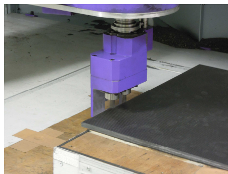
図 2-19 タンデムトリムヘッドでの加工
