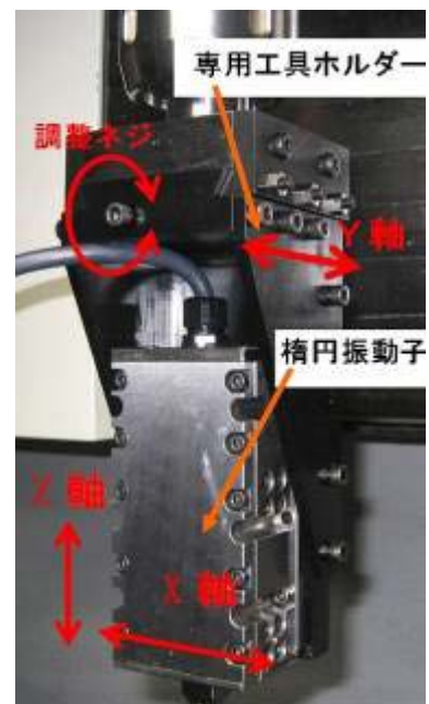
図 2-1-1-4 当初開発した専用工具ホルダーとそれに装着した従来型楕円振動子
