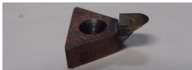
図 2-2-1-1 逃げ角 45^\circ のインサート工具（ノーズ半径 1mm）
