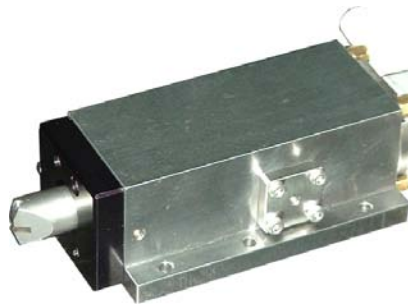
図 1-1-4 多賀電気が世界で初めて実用化に成功した超精密超音波楕円振動切削装置 EL-Σ 50. 2007 年度精密工学会技術賞を受賞.
