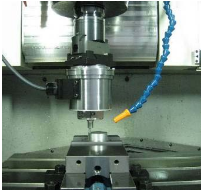
図 2-1-1-2 改善した自由曲面角隅加工用楕円振動切削装置 II
