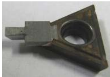
(a) 設計した専用インサート工具 (b) 実際に試作した工具
