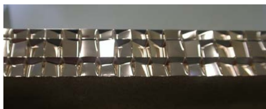
図 1-1-1 角隅を有するリン青銅の鏡面加工
