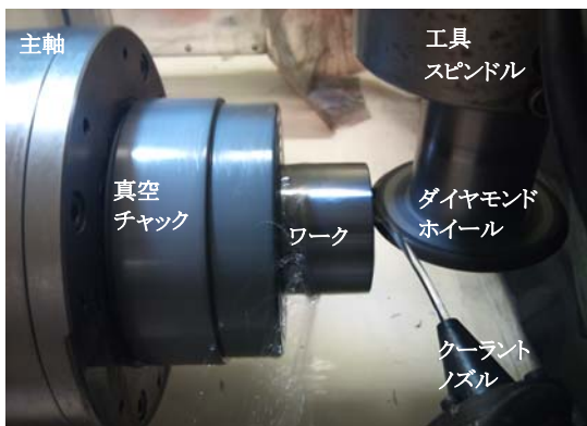
図 6.23 フレネル形状の研削加工の外観
