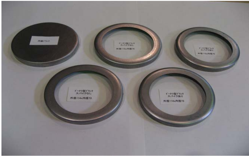
図9. 絞り成形された各種試作品
