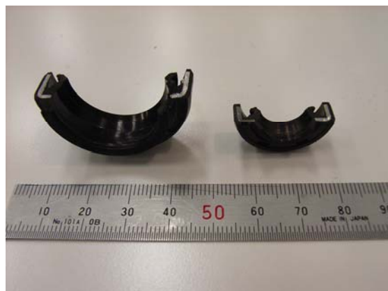
図4. ショックアブソーバー用シール部品断面 (金属製部品をゴムでコーティング)
