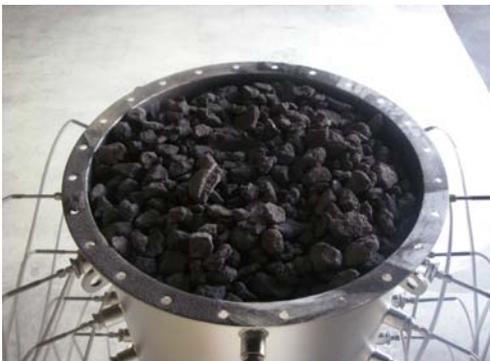
図 30 φ650 実験装置に 30mm コークス充填
