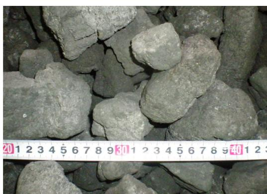
図1 実験用高炉コークス（粒度：40-80mm）
