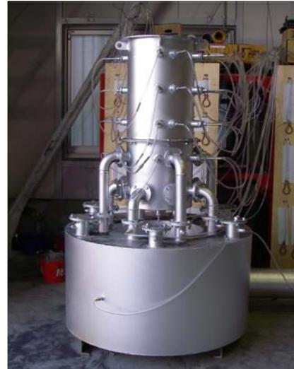
図 29 φ400-2 段羽口実験装置
