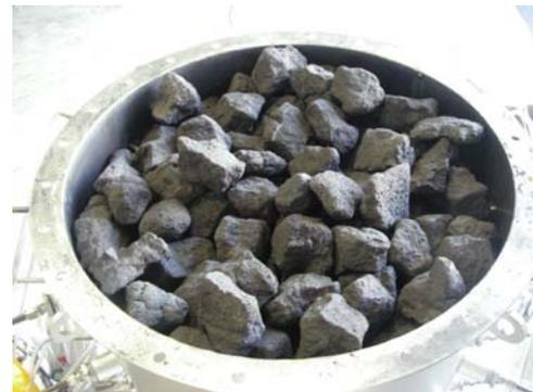
図 31 φ650 実験装置に 120mm コークス充填
