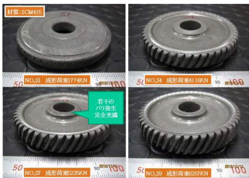
図④-2-4 各スライド条件別 SCM415 材の成形状態
