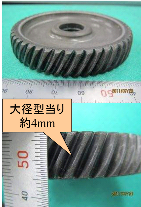
図④-2-12 ヘリカルギヤの2段成形モーションの成形状態
