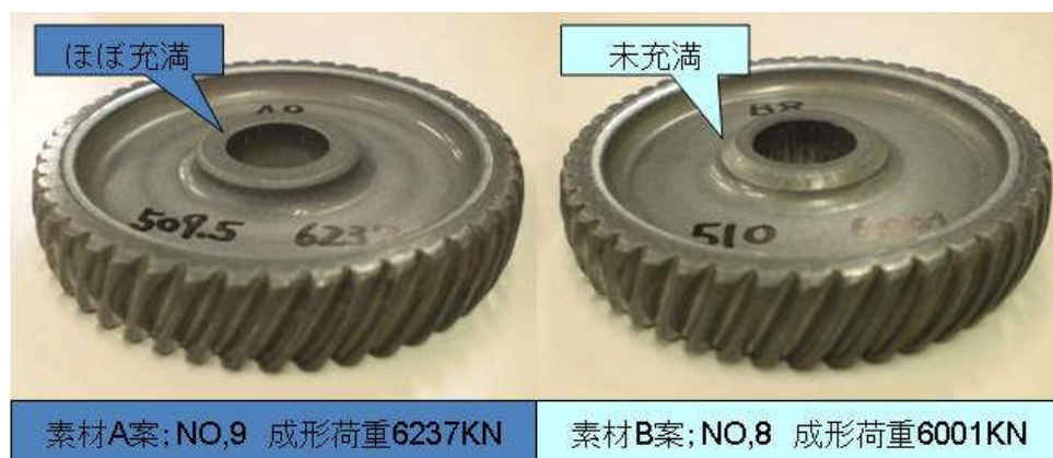
図④-2-8 SCM415 材 素材形態別 鍛造状態写真
