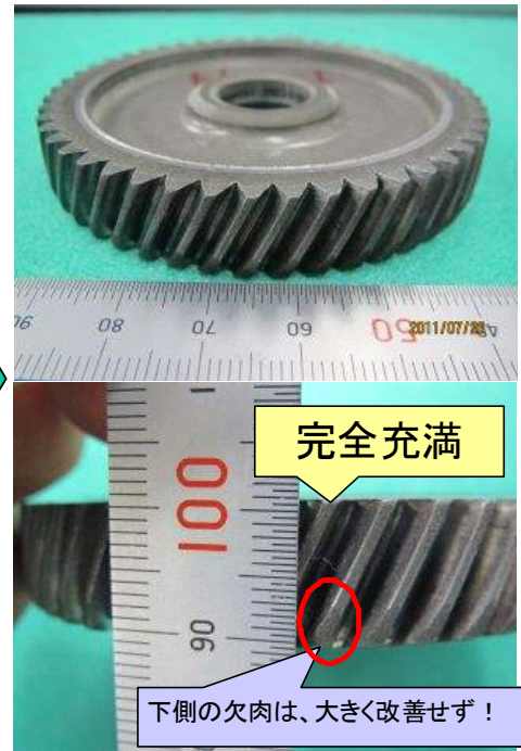
図④-2-12 ヘリカルギヤの2段成形モーションの成形状態
