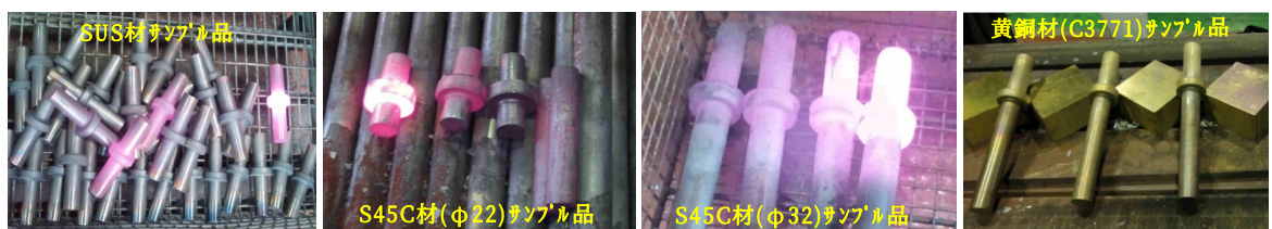
図-14: アプセット鍛造後(鋼材及び非鉄金属)のサンプル品
