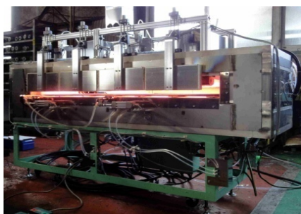
図-23:素材部分加熱炉
