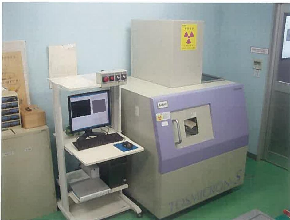
図 2－5－2 X 線透視検査装置の外観写真
