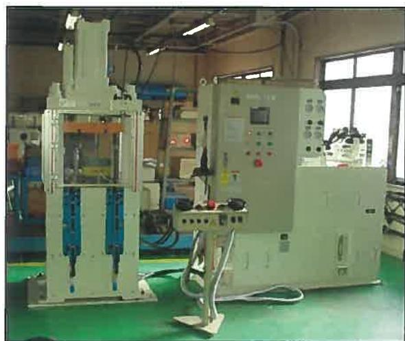
図2-4-1 塑性結合プレス機の概要
