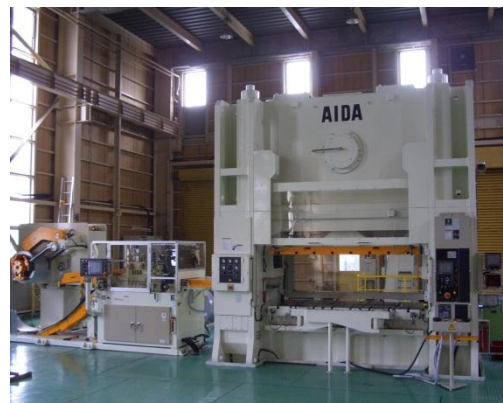
図 2.4.7 実験用プレス機械
