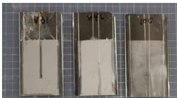
図 8 Al/複合材料接着はく離試験後の写真 (はく離試験後においてもアルミニウム側に複合材料が残存している)
