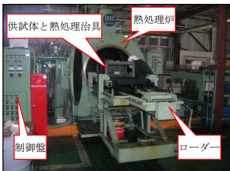
図 2-2-1 熱処理炉
