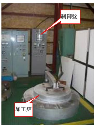
図 2-2-3 電気炉
