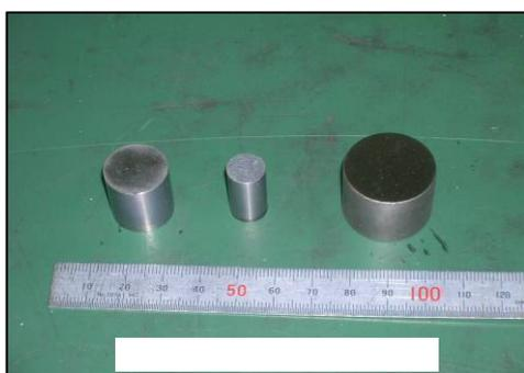
図4-3-1 温度測定用テストピース
