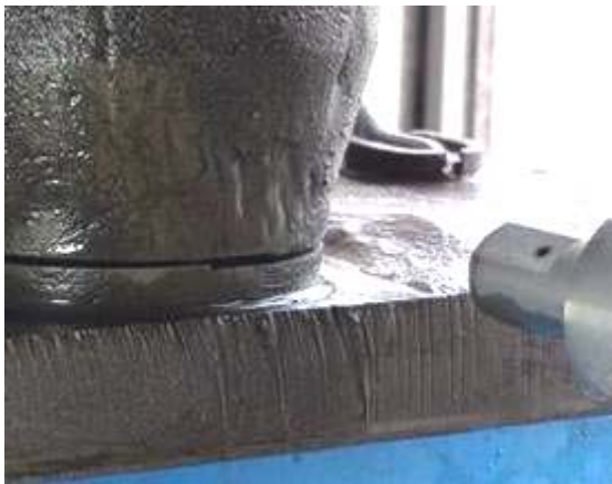
Fig. 2.8.1 高圧水吐出 切断部
