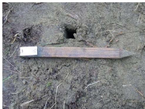
図 2.3.13 野外試験装置(4) 処理杭 (3.5×3.5×35 cm)
