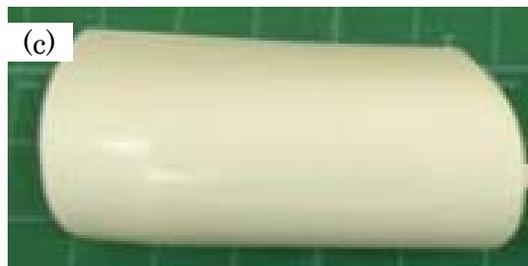
写真 2-1-27 成形品(a)ABS 樹脂、(b)PC 樹脂、(c)PA6 樹脂
