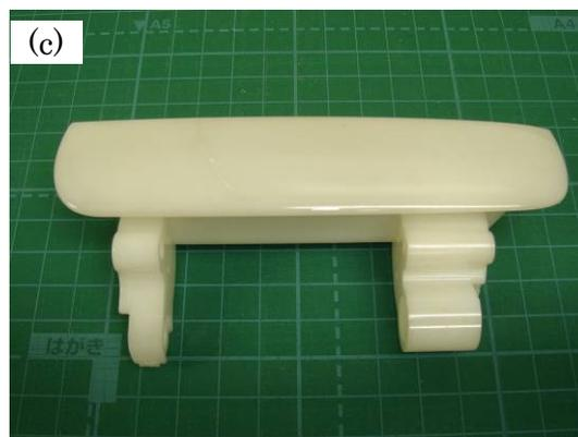
写真 2 - 2 - 5 PC 樹脂成形品(a)素材、(b)TES 処理、(c)触媒付与後
