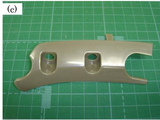
写真 2 - 2 - 4 ABS 樹脂成形品(a)素材、(b)TES 処理、(c)触媒付与後
