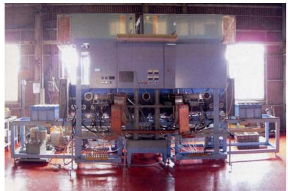
図 1-3-③ 連続式多軸通電焼結装置
