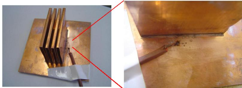
Cu ヒートシンクには、熱電対をスポット溶接した
