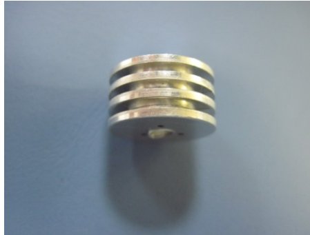
図 2.3.2-1 試作アルミニウムリフレクタ ( \Phi 16\text{mm} \times 4 、 \Phi 10\text{mm} \times 3 合計7枚積層)
