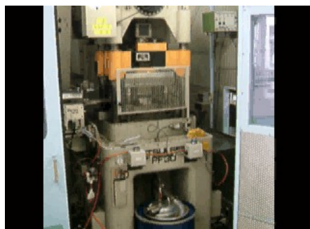
図 2.1.3-1 耐久性評価用順送プレスマシン
