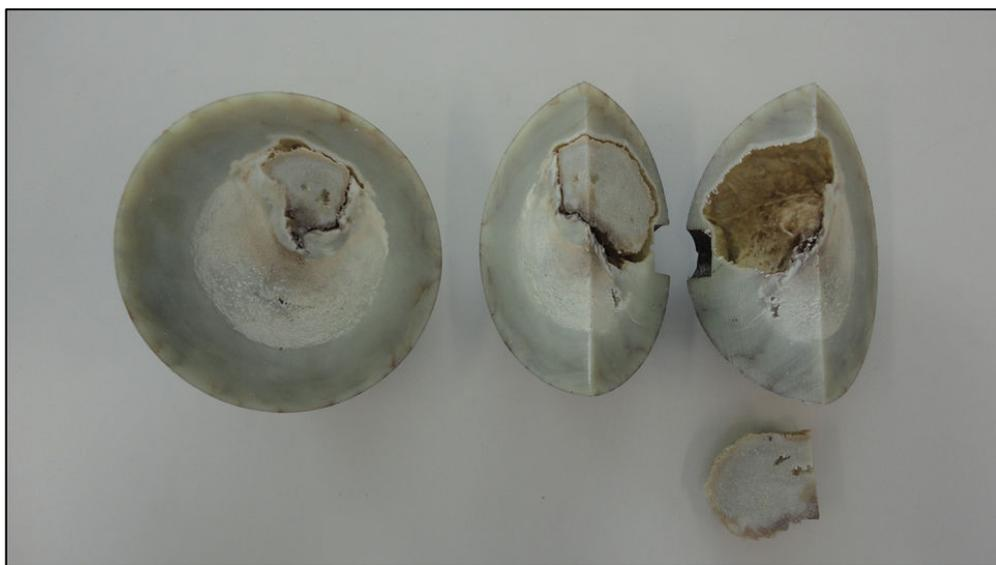
図 81 3回目の成形結果(試作5)
