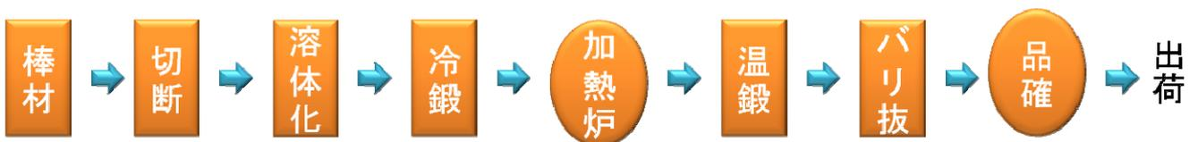
図3-1 ターゲット部品製造工程
