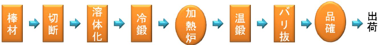
図3-6 ターゲット部品製造工程
