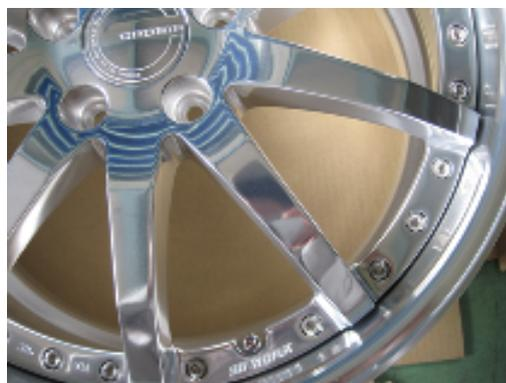
図 1 1 粉体クリアー塗装⇒高温乾燥 図 1 2 溶剤クリアー塗装⇒低温乾燥
