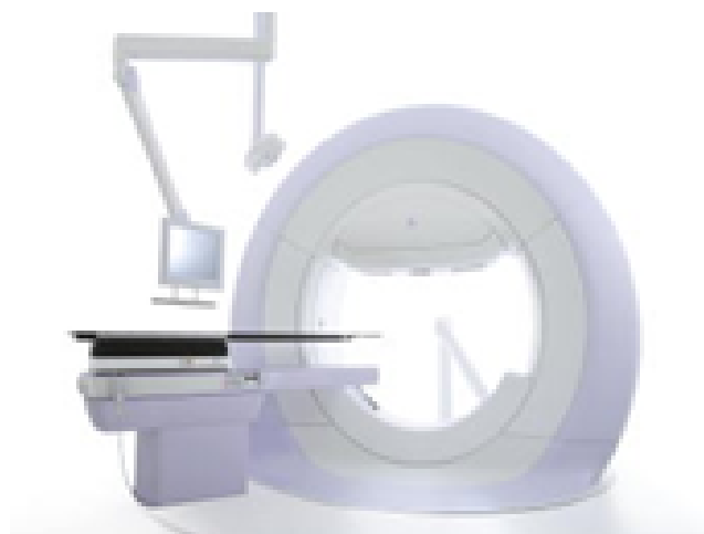
写真 1.1-1 三菱重工業(株)が開発した最先端画像誘導放射線治療装置(MHI-TM2000)
