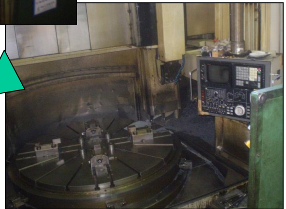
図3.3-8-1 事前加工に使用したNCターニング(立形旋盤)加工機
