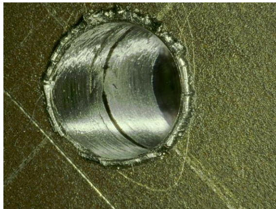
写真 1.3-4 一般の機械で加工した例（穴の面が粗いことが分かる）
