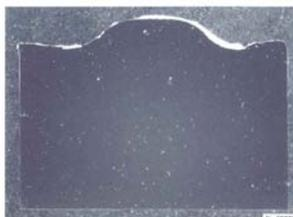
図 4-5 接合ツール断面図
