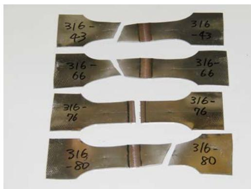
図 4-4 引張試験後の試験片
